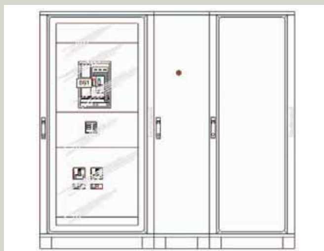
Отображение шкафа с дверями и кнопкой аварийного останова, расположенной на двери кабельной секции.
