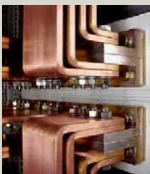
Подключение четырех шин сечением 100 x 10 мм к каждому заднему выводу аппарата DMX 4000 выкатного исполнения
