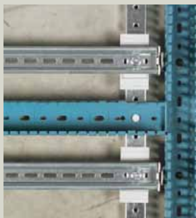
Фиксация вертикального жгута проводов.
