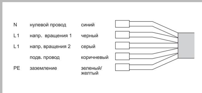
Подключение скатывающего устройства с шнуровым выключателем
