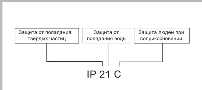
Корпус данного устройства предотвращает:
