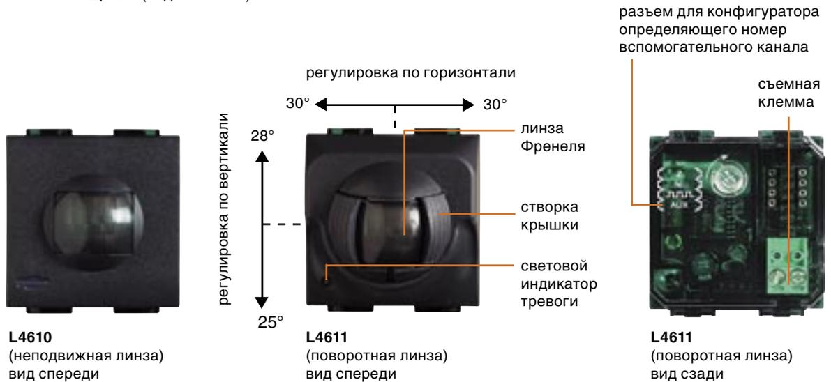
Поскольку пассивные ИК-датчики не способны создавать и посылать команды на один или более активаторов, их используют в сочетании с управляющим устройством арт. L4651/2. В этом случае связь между датчиком и управляющим устройством обеспечивается посредством вспомогательного канала (номер канала определяется конфигуратором с номером в разъеме AUX ИК-датчика и управляющего устройства). Таким образом, при обнаружении человека, ИК-дат-
