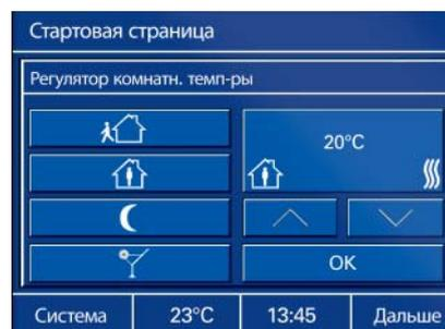
Пульт управления может, помимо всего прочего, использоваться также как регулятор температуры для одного из помещений. Интегрированный датчик обеспечивает автоматически комфортную температуру в помещении.
